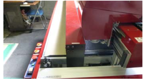
軟質PVC向けに開発した押さえ機構
